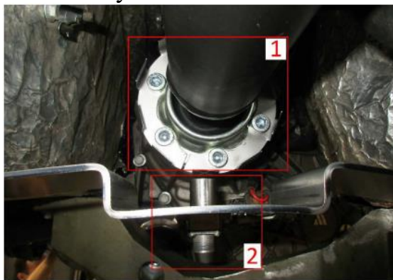
Рисунок 3.7 – Монтаж датчика частоти обертання на задньому карданному валу трансмісії: 1 – металева гребінка; 2 – імпульсний датчик ІС445
