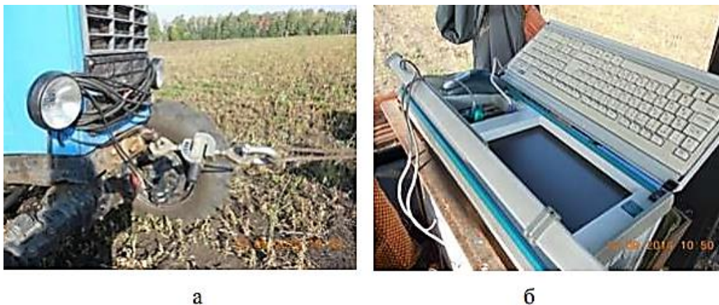
Рисунок 3.17 – Обладнання для проведення експерименту та обробки експериментальних даних: а) динамометр; б) багатоканальний вимірювальний обчислювальний комплекс МІС-400D
