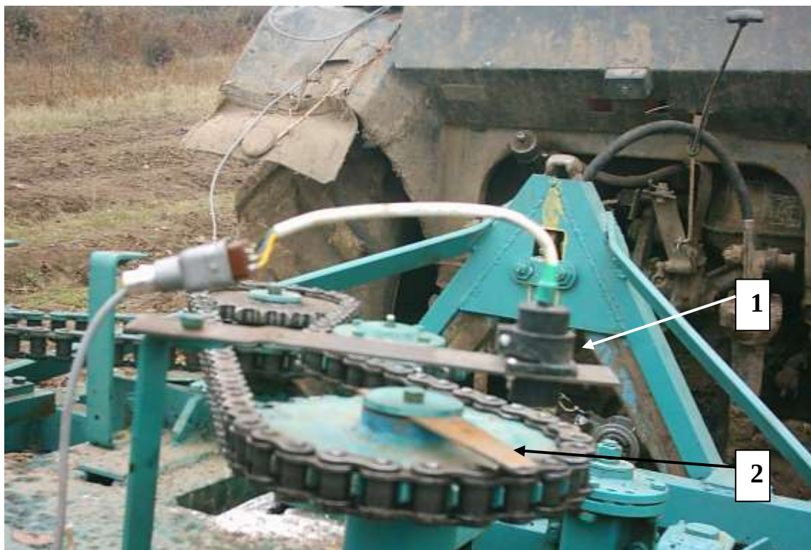
Рисунок 3.4 – Встановлення датчика ДЧВ-1 на пристрої: 1 – датчик ДЧВ-1; 2 – стрілка-показчик.
