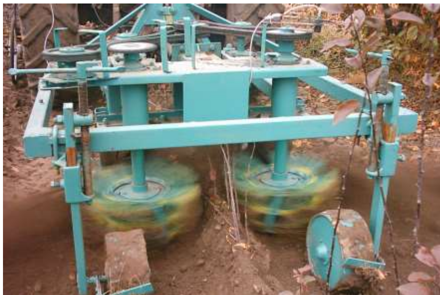
Рисунок 3.8 – Валок ґрунту, що залишається після проходу пристрою
