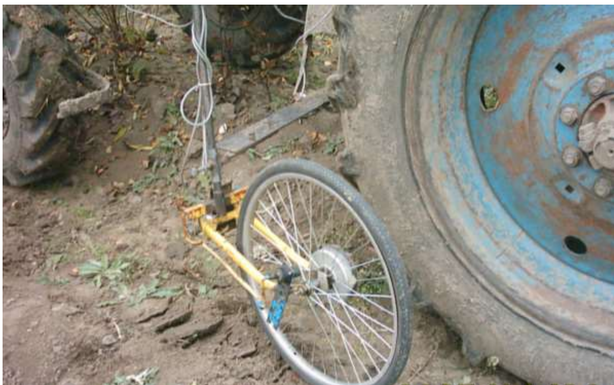
Рисунок 3.5 – Шляховимірювальне колесо, встановлене на агрегаті
