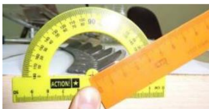
Рисунок 2.8 – Вимірювання кута атаки горизонтальних зубчастих подрібнюючих елементів.
