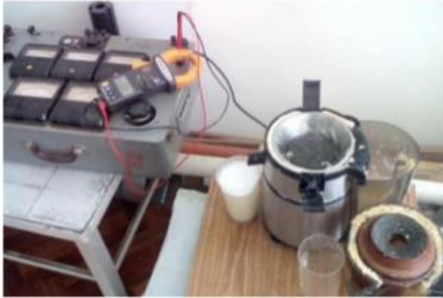
Рисунок 2.3 – Загальний вигляд експериментальної установки подрібнювача замоченого зерна сої зі змінними абразивними дисками.
