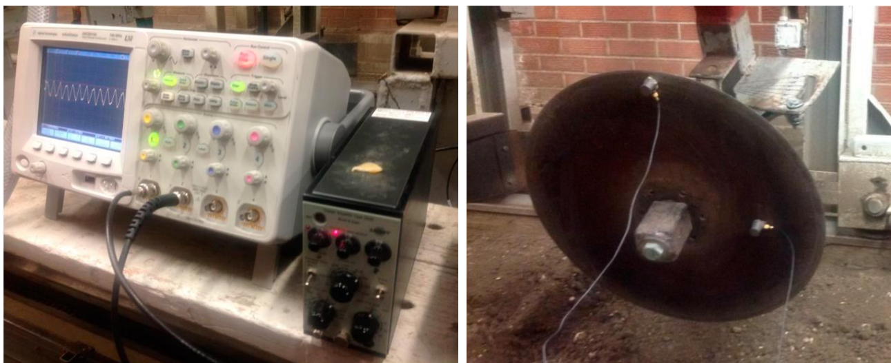
Рисунок 4.1 – Акселерометр для перевірки власної частоти
