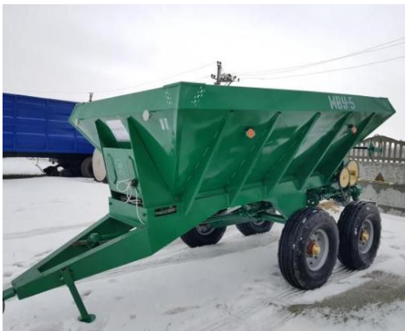
Рис. 2.1 -Удосконалення на робочого органу розкидача мінеральних добрив МВУ-5 (вид з боку)
