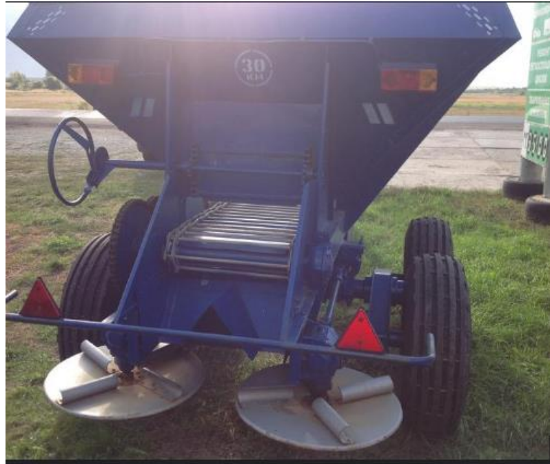
Рис. 2.2 -Удосконалення на робочого органу розкидача мінеральних добрив МБУ-5 (вид заду)
