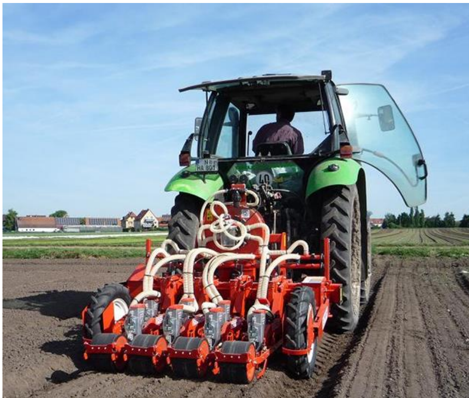
Рисунок 1.3 – Овочева сівалка точного висіву Orietta виробництва Gaspardo
