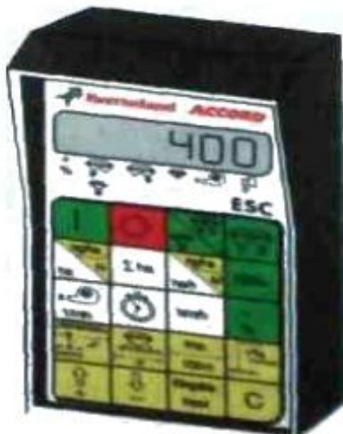
Рисунок 1.8 – Монітор електронної системи керування та контролю роботи сівалок «Miller Electronic»
