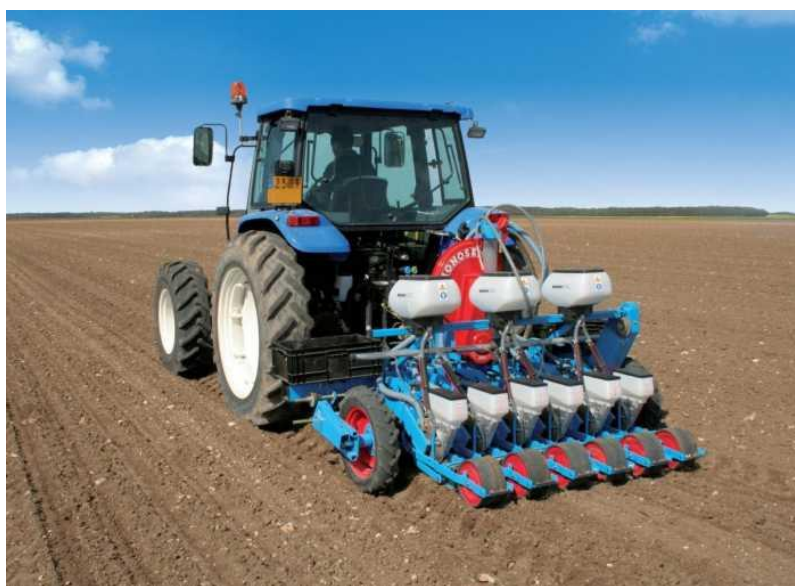
Рисунок 1.4 – Овочева сівалка точного висіву моделі MS A виробництва Monosem
