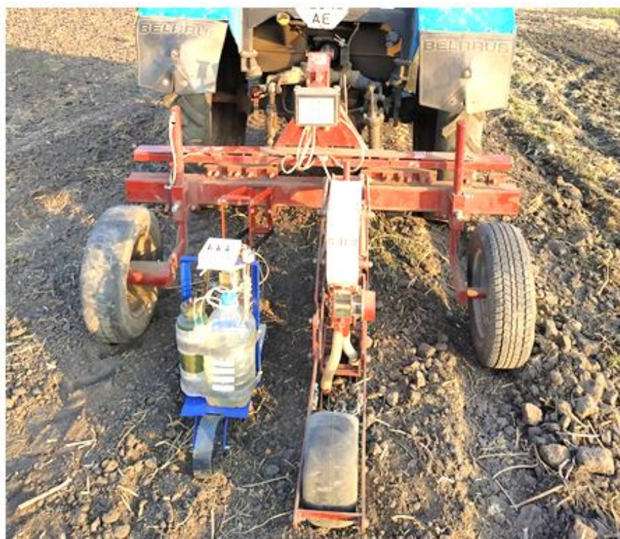
Рисунок 3.13 – Процес висіву томату «Солероссо» дослідною гідросівалкою та штатною секцією сівалки «Клен»
