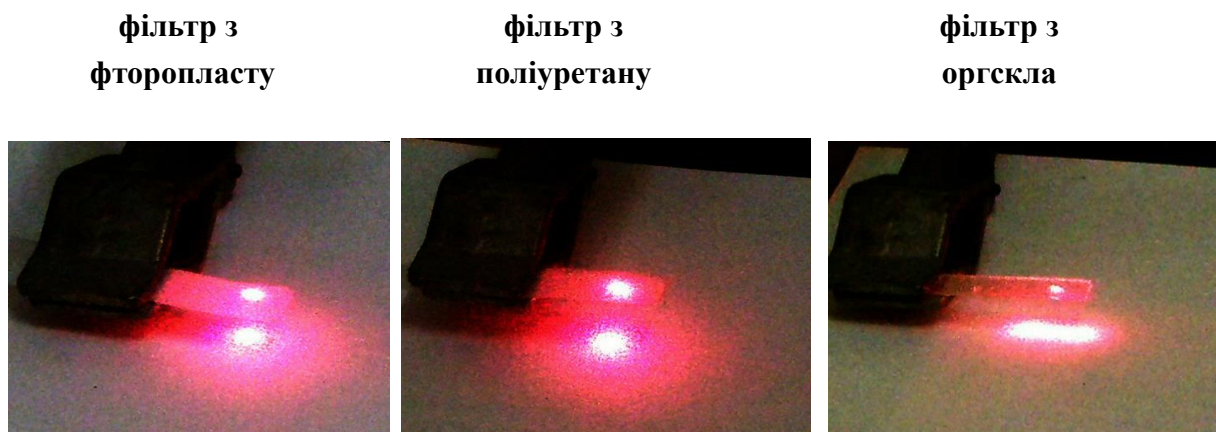
Рисунок 3.4 – Розсіювання світлового променя різними типами фільтрів
