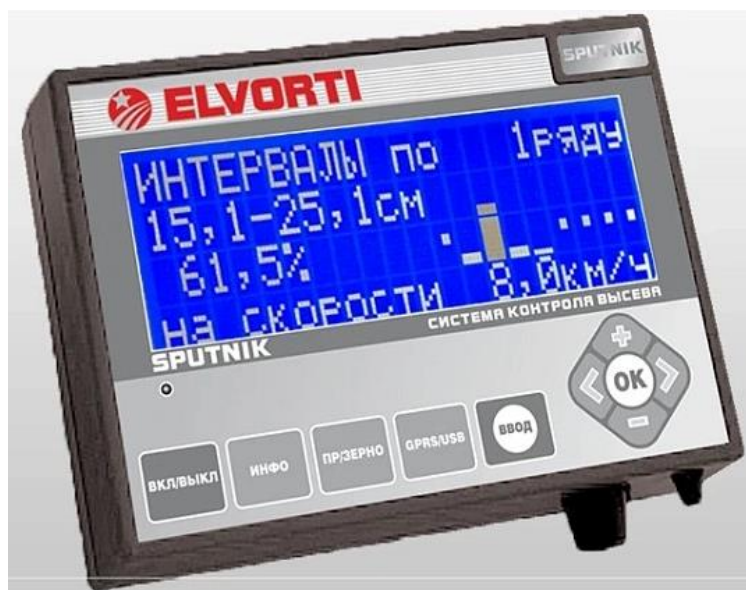
Рисунок 1.10 – Електронна система керування та контролю «Sputnik» компанії Elvorti
