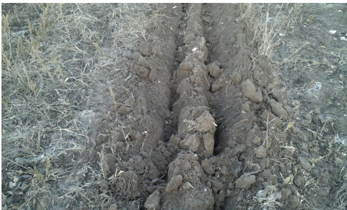
Рисунок 4.2 – Стан деблокованої канави після проходу експериментальної установки з новим робочими органами
