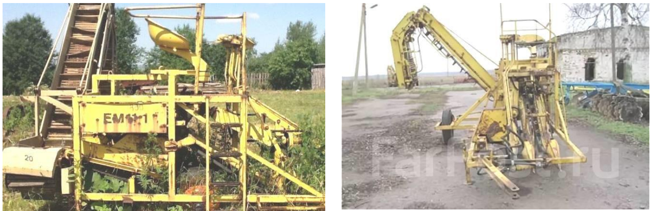
Рисунок 1.1 – Загальний вигляд машини для збирання столових коренеплодів на рівній поверхні з обрізуванням гички, очисткою та завантаженням коренеплодів у транспортний засіб ЕМ-11
