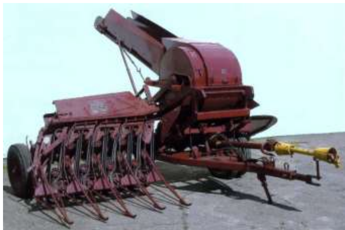
Рисунок 1.1 – Льонокомбайн ЛК-4А с верхніми центральними стеблопідводами подільників змінної кривизни
