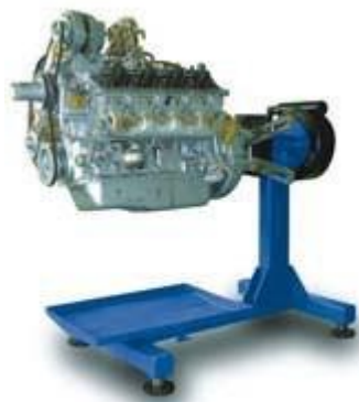
Рисунок 2.1 – Універсальний стенд Р-500Е для розбирання та складання двигунів і агрегатів
