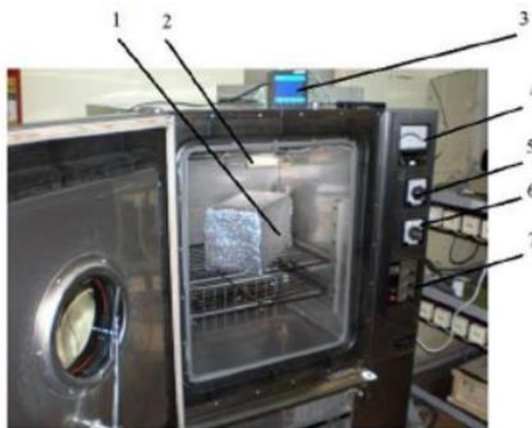
Рисунок 3.2 – Камера для випробувань із встановленим зразком
