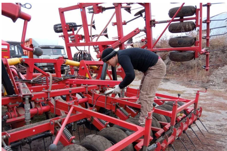
Рисунок 1.9 – Технологічна операція змащення перед зберіганням техніки.
