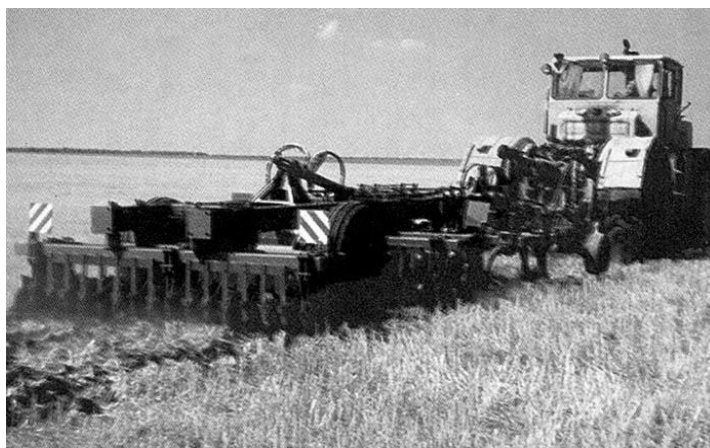
Рисунок 1.6 – Комбінована машина для передпосівного обробітку ґрунту АГРО-3
