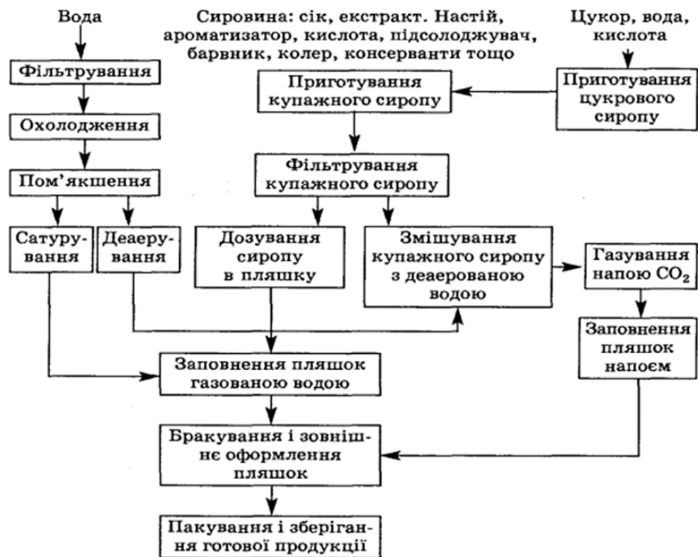
Рисунок 1.1 — Принципово-технологічна схема виробництва безалкогольних напоїв на основі соку та інших натуральних компонентів
