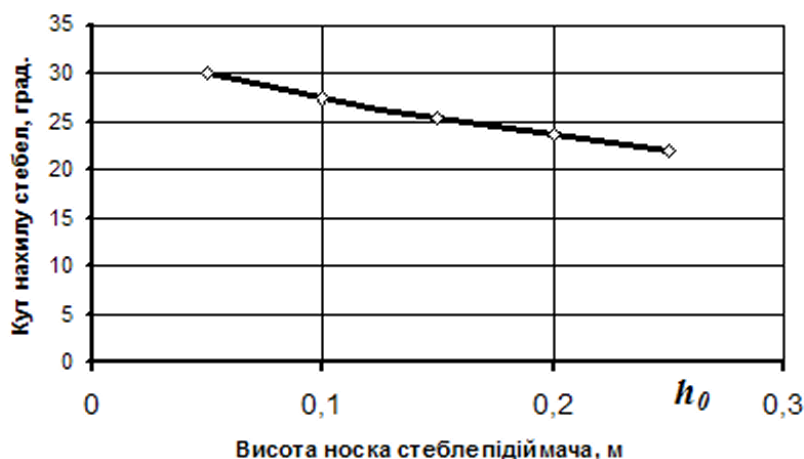
Рис. 2.5. Залежність кута нахилу стебел від висоти розміщення вершини стеблепідіймача
