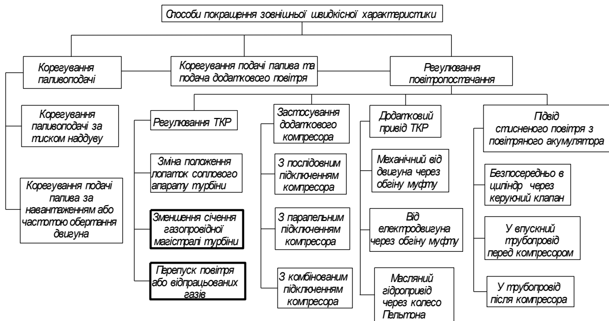
Рис. 1.1. Класифікація способів покращення енергетичних та паливо-економічних показників дизеля з газотурбінним наддувом
