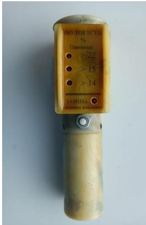
Рисунок 2.16 - Загальний вигляд індикатора вологості зерна
