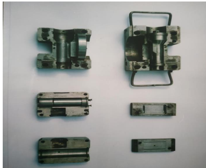
Рисунок 2.14 – Загальний вигляд пресформ для виливу корпусу, кришки корпусу та ручки індикатора
