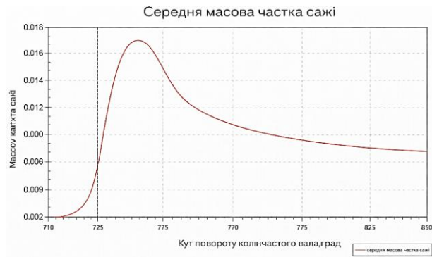
Рис. 4.15. Масова частка сажі від кута КВ: третя геометрія (ОСС).
