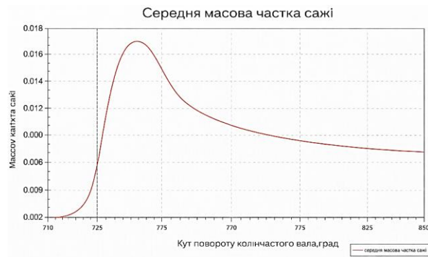
Рис. 4.14. Масова частка сажі від кута КВ: друга геометрія (SCC)
