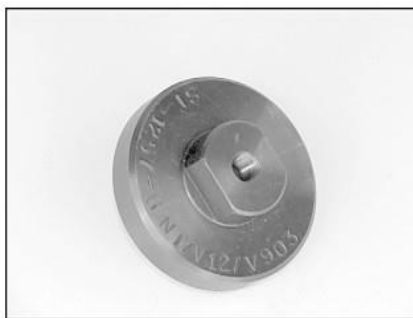
Рис. 1.18. Приєднувальна муфта (стакан) ST-1257-6 для підключення вакуумметра
