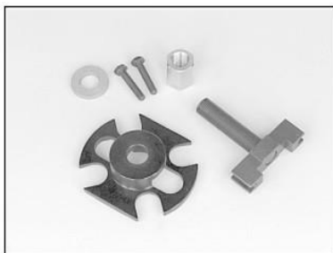
Рис. 1.14. Пневматичний пристрій 3164321 (Cummins) демонтажу пружин
