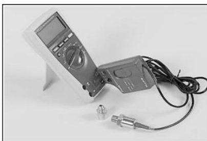
Рис. 1.17. Прецизійний вакуумметр 3164491 (Cummins) для контролю
