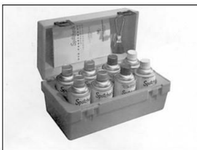
Рис. 1.16. Портативний дефектоскоп OEM1272 виявлення втомних тріщин
