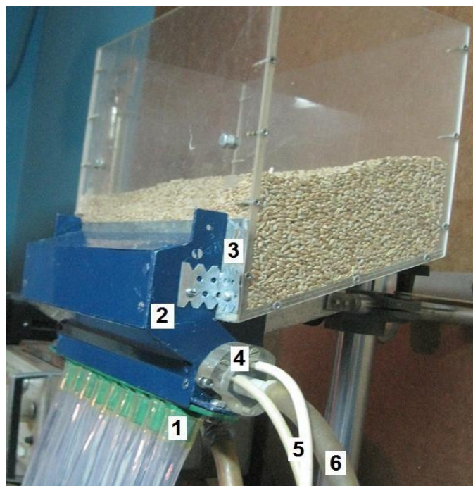
Рисунок 3.7 – Зовнішній вигляд запропонованого висівного апарата з вихровим клапаном для висіву зернових культур: 1 – насіннєпроводи; 2 – корпус висівного апарата; 4 – вихровий клапан; 5 – керуючі повітряні лінії; 6 – живильний
