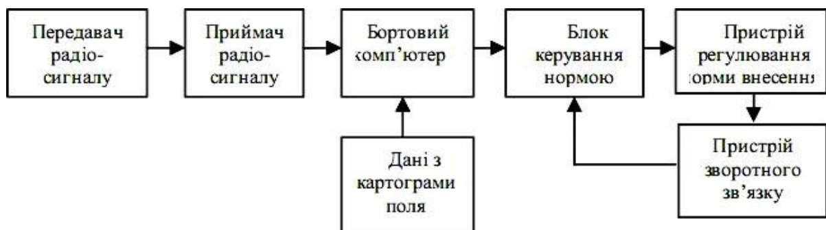
Рисунок 1.7 – Принципова схема функціонування системи автоматизованого керування нормою висіву.
