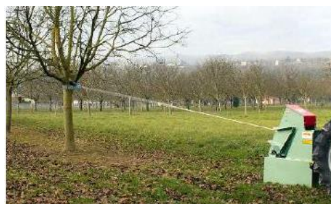
Рисунок 1.5 – Тросовий вібраційний струшувач плодів моделі SEC французької фірми AMB ROUSSET
