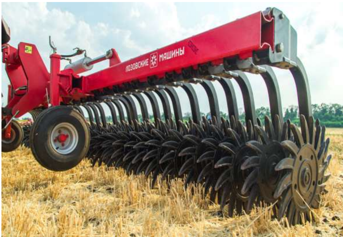
Рисунок 1.2 – Варіант цільнолитого виконання колеса ротаційної борони (важка борона)
