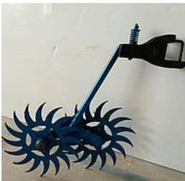
Рисунок 1.2 – Варіант цільнолитого виконання колеса ротаційної борони (важка борона)
