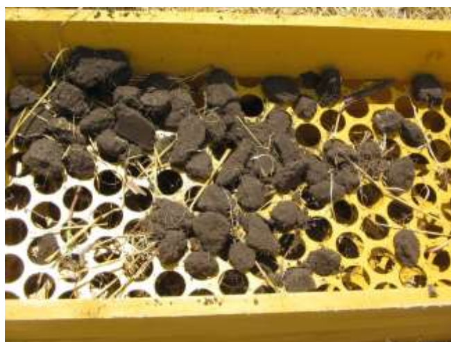
Рисунок 3.11– Просіювання взятої проби ґрунту на решеті
