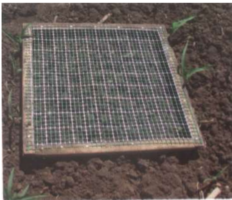
Рисунок 1.12 – пристосування для визначення повноти руйнування ґрунтової кірки [31].
