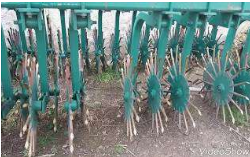
Рисунок 1.10 – диски борони з лопатовидними кінцівками голок.
