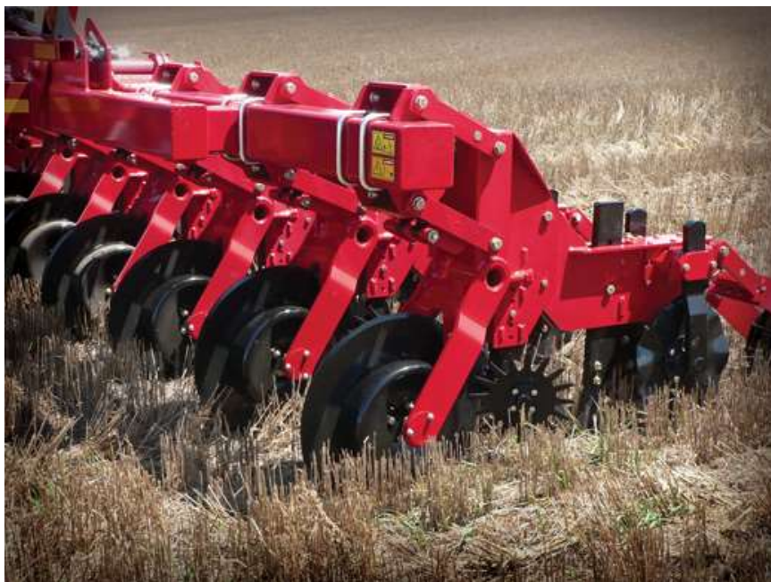
Рисунок 1.5 – Секція ротаційної борони в складі комбінованого ґрунтообробного агрегату : 1 – рама; 2 – колтер; 3 – секція ротаційної борони; 4 – секція турбодискова; 5 – долотоподібний глибокорозпушувач.
