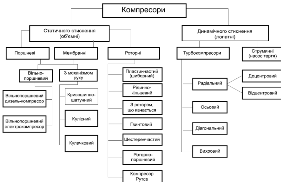
Рисунок 2.1 – Загальні характеристики та типи компресорів
