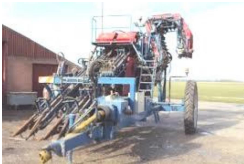
Рисунок 1.5 – Загальний вигляд комбайна для збирання моркви Asa-Lift
