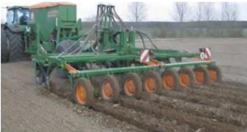
Рисунок 1.21 - Досвідчений зразок машини смугової обробки ґрунту з робочою шириною 6 метрів, фірма AMAZONE.
