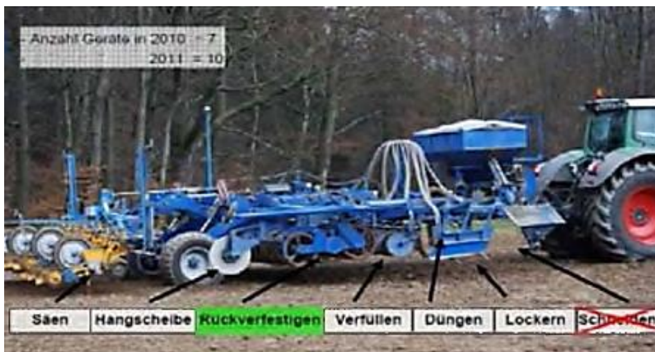
Рисунок 1.19 – Машина для смугової обробки ґрунту під цукрові буряки (2011 р.) [8, 14].
