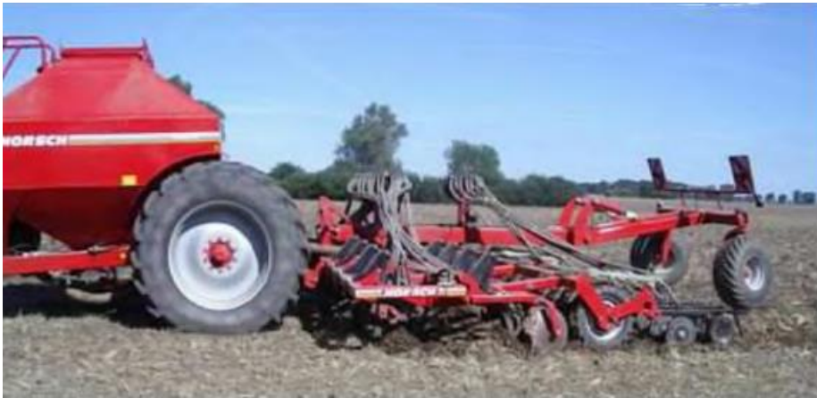
Рисунок 1.20 - Машина Focus для смугового обробітку ґрунту під зернові культури з робочою шириною 6 м, фірма HORSCH.
