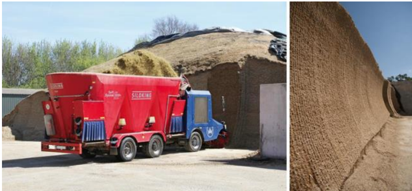
Рисунок 1.3 -Самохідний роздавачі формується зріз після виїмки кормів із траншеї фрезерним обладнанням.
