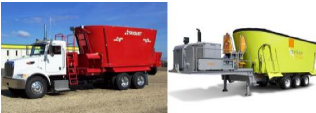
Рисунок1.4 -Самохідний і причіпний кормозмішувач на вантажному шасі
