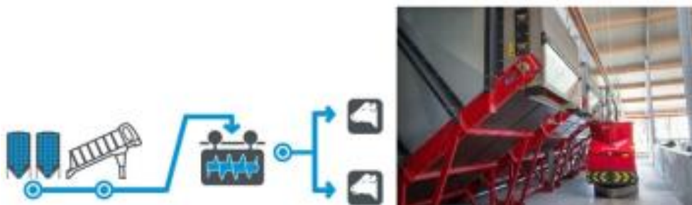
Рисунок1.11 -Схема автоматичної системи годівлі №2 (зліва); Кормовий вагон Triomatic WP 2 300 і кормова кухня Triomatic T30 (праворуч).
