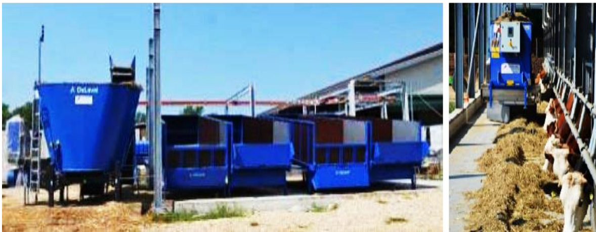
Рисунок 1.16 – Склад автоматичної системи годівлі: змішувачі бункери-накопичувачі (ліворуч), кормовий вагон (праворуч)[31]
