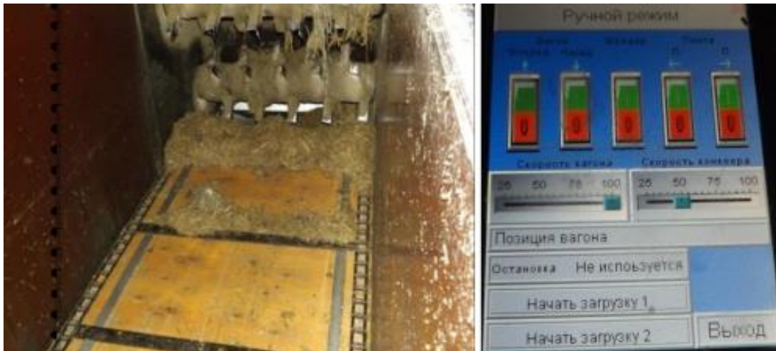
Рисунок 3.7 -Поздовжній транспортер і бітерний пристрій (зліва); сенсорний дисплей (праворуч).
