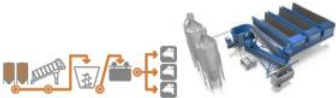
Рисунок 1.12) -Схема автоматичної системи годівлі №3 (зліва); Система DeLaval Optimat Master (праворуч).
