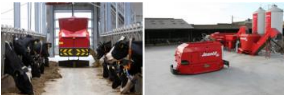
Рисунок 1.9 -Підвісний кормовий вагон Triomatic HP 2 300 (зліва); кормовий вагон нашасі Jeantil Automatic Feeding (праворуч)
