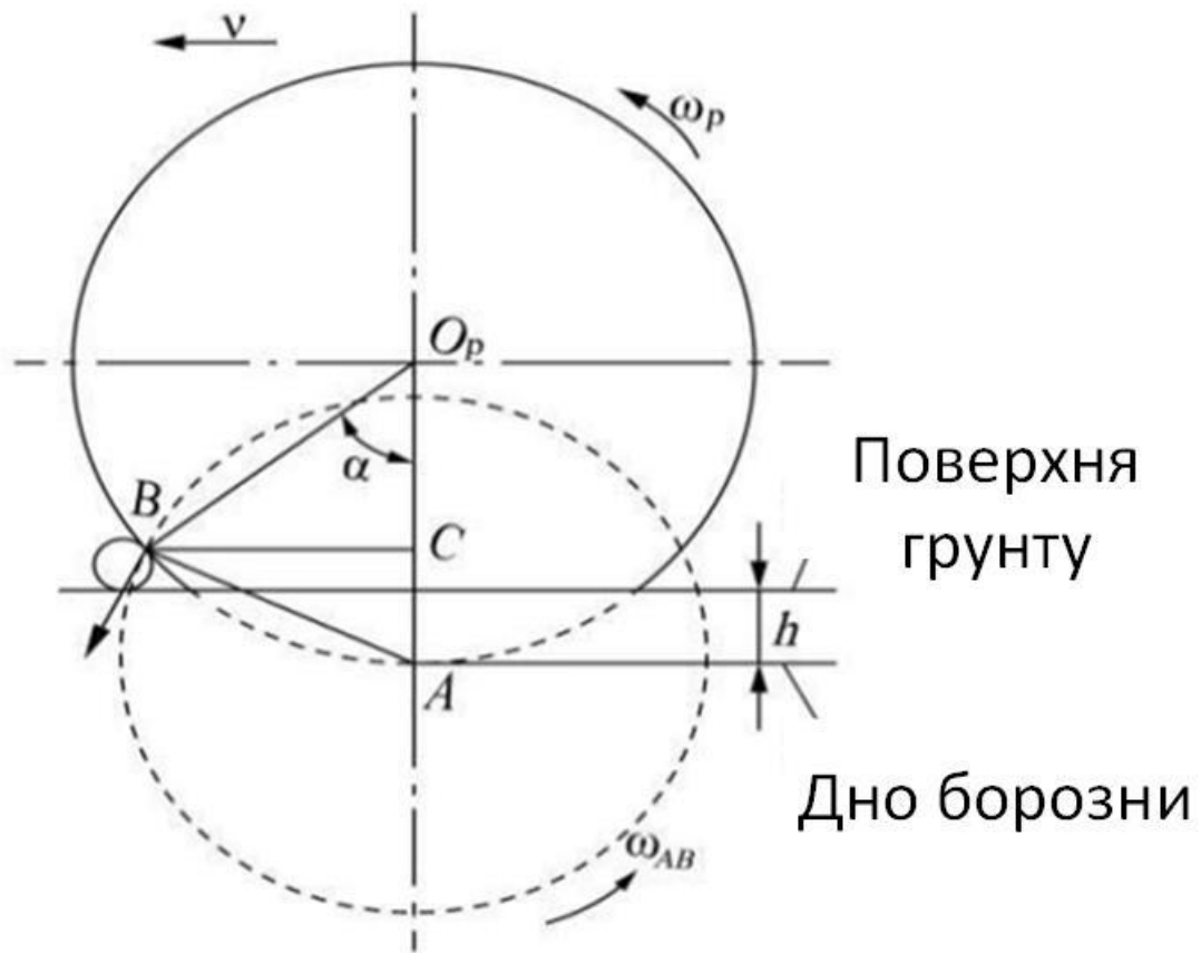
Рисунок 2.3. Аналіз миттєвої швидкості диска, що розрізає стебло:
