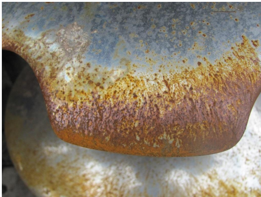
Рис. 2.12 Поверхня диска борони «Gregoire Besson» після напрацювання 3340 га, термін зберігання після роботи 27 днів
