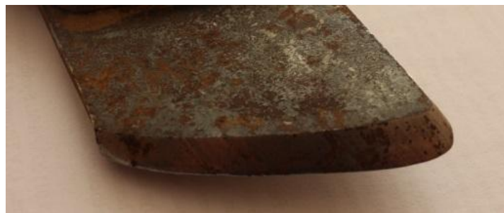
Рис. 2.5. Формоутворення різального елемента змінного долота леміша (експлуатація на супіщаних ґрунтах)
