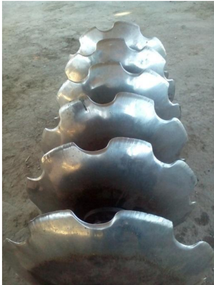
Рис. 2.11. Секція борони БПД-4,2 після напрацювання 1282 га, термін зберігання після роботи 45 год
