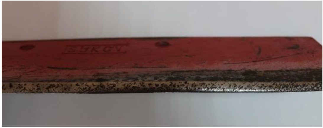
Рис. 2.6. Формоутворення різального елемента леза леміша(експлуатація на легкій глині)
