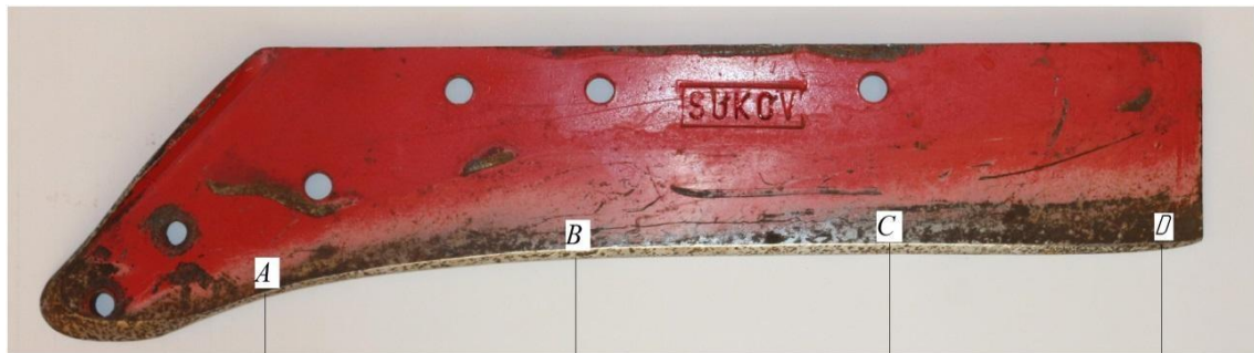
Рис. 2.6. Формоутворення різального елемента леза леміша(експлуатація на легкій глині)
