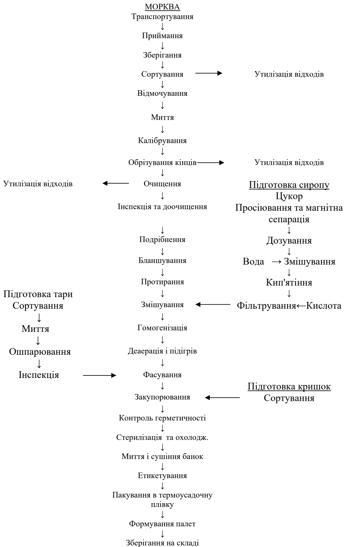
Рис.2.3. Технологічна схема виробництва консервів «Сік морквяний «Янтарний»
